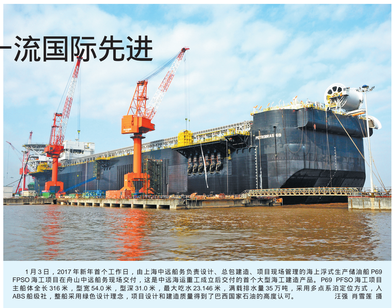
1月3日,2017年新年首个工作日,由上海中远船务负责设计、总包建造、项目现场管理的海上浮式生产储油船P69 FPSO海工项目在舟山中远船务现场交付,这是中远海运重工成立后交付的首个大型海工建造产品。P69 FPSO海工项目主船体全长316米,型宽54.0米,型深31.0米,最大吃水23.146米,满载排水量35万吨,采用多点系泊定位方式,入ABS船级社,整船采用绿色设计理念,项目设计和建造质量得到了巴西国家石油的高度认可。汪强 肖雪莲 摄
