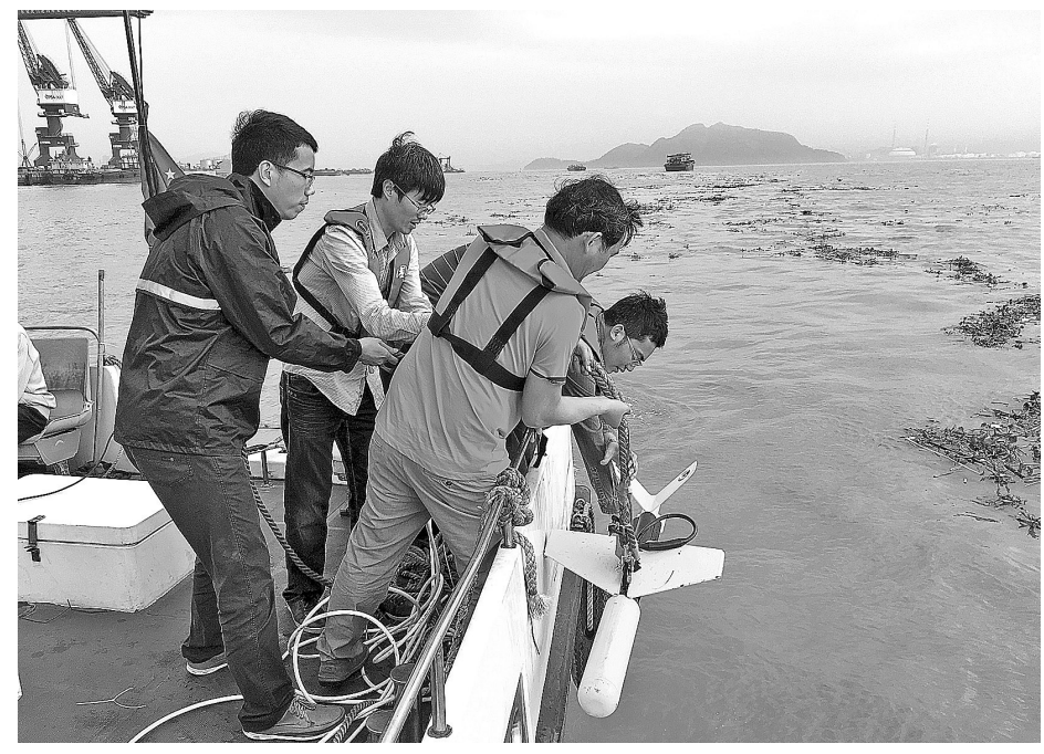
测量分队使用hydroscan旁扫声纳执行应急扫测任务。广州海测供图
