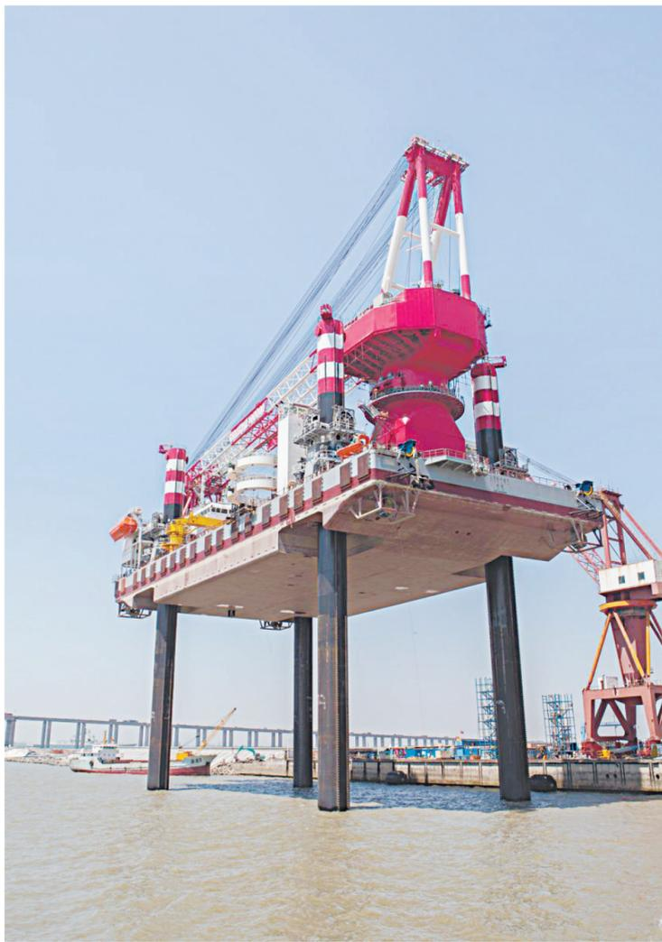
4月8日,由振华重工建造的世界最大2000吨风电安装平台“龙源振华叁号”在海工平台事业部进行全程抬升试验。上午10时30分,该平台顺利升船至桩腿80米处,到达限位位置,船体停留1小时后,顺利下降至预定高度。据悉,它是集大型设备吊装、风电设备打桩、安装于一体的风电施工平台,居目前世界同类平台之首。黄玲 徐强强 摄
