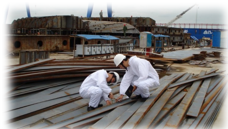
肖向锋(左)和同事对新建船舶的钢材厚度进行校核。
