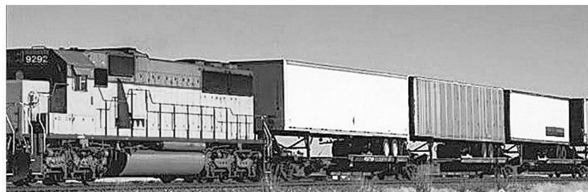
△驮背运输让货车直接上火车,减少了中间转运环节,节省了时间和物流成本。
