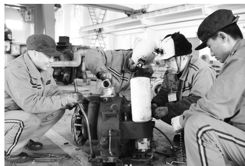
工作室通过“技师一带一”活动,现场指导工人组装柴油机缸头。
