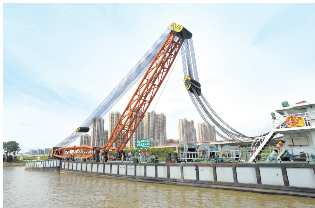
6月26日,苏州地方海事大型打捞船“苏州救捞01”在运河完成试航实验。该船是江苏地方海事部门自主拥有的最大内河打捞船,总长49.5米,船宽13米,由一只主浮箱和六只边浮箱组成,最大起重能力为500T。顾晓平 王永伟 摄
