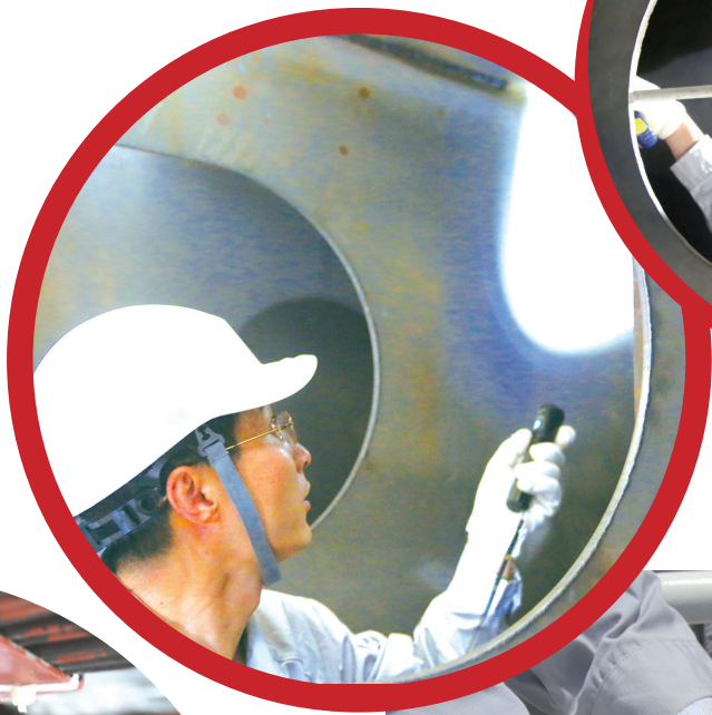
▲廖正勇打开手电照亮船舶内部，检查开口尺寸是否和审批过的图纸一样。
