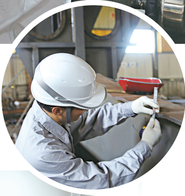
▶廖正勇测量钢板厚度。
