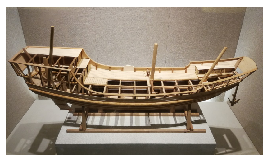
福船剖解结构模型。
