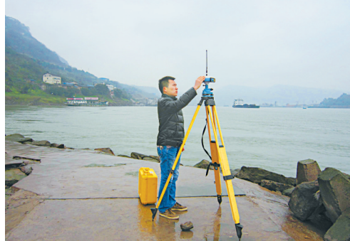
陈志勇在燕子矶测量现场架设GPS基站。
