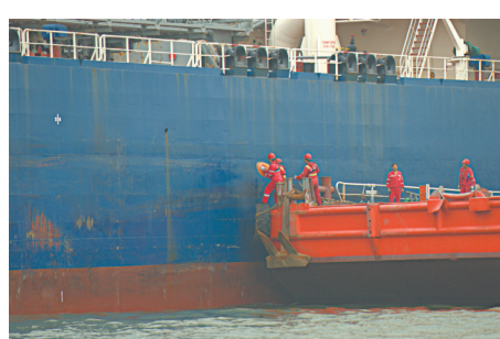
对船舶破损部位进行堵漏作业。
