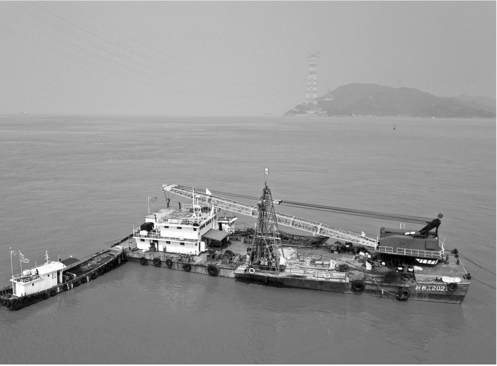
3月11日,舟山市定海区金塘岛西堠门水道,勘探船进行甬舟铁路海中勘察。姚峰 摄
