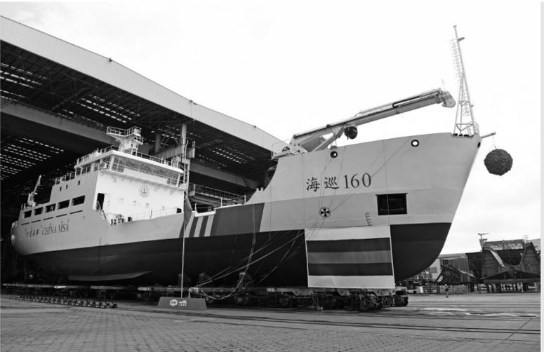
3月22日,交通运输部东海航海保障中心2200吨级大型航标船在江南集团长兴基地顺利下水。该船总长73.3米,型宽14米,型深6.20米,最大排水量2200吨。该船主要用于对东海海区各港口航道的灯浮标和助航设施进行布设、撤除、检查和维护工作,并能兼顾海上防污染和无线电导航信号监测等任务。管登红 虎皓严 摄
