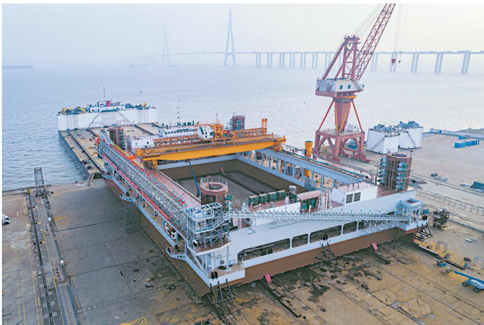
4月9日,由中交第一航务工程局有限公司、上海振华重工(集团)股份有限公司联合研发建造的自升式碎石铺设整平船“一航津平2”号在南通下水,该船铺设整平作业最大水深40米,每4个船位即可完成单个沉管的抛石整平作业,被誉为深水碎石铺设的“3D打印机”。
