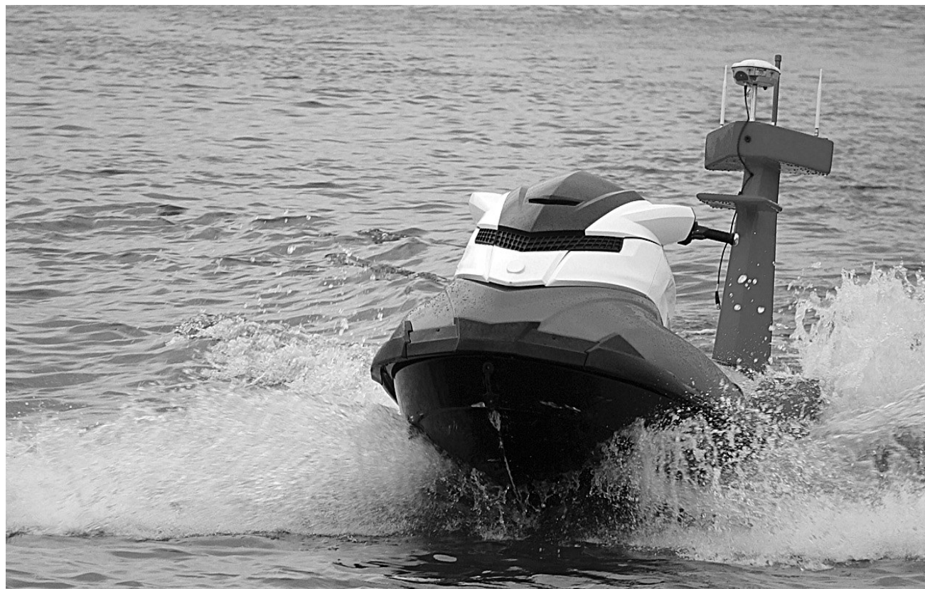
无人艇进行水下地形测量。刘勇供图
