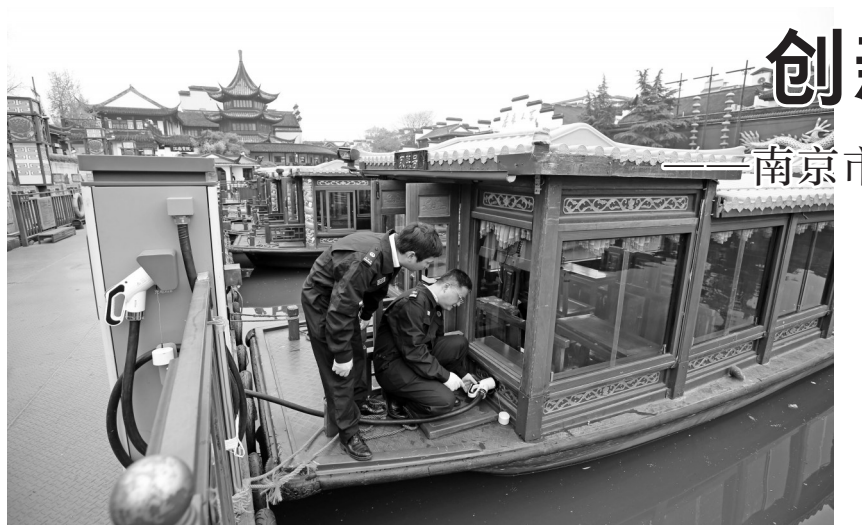
验船师为旅游船进行岸基充电性能检查。南京市地方海事局供图
