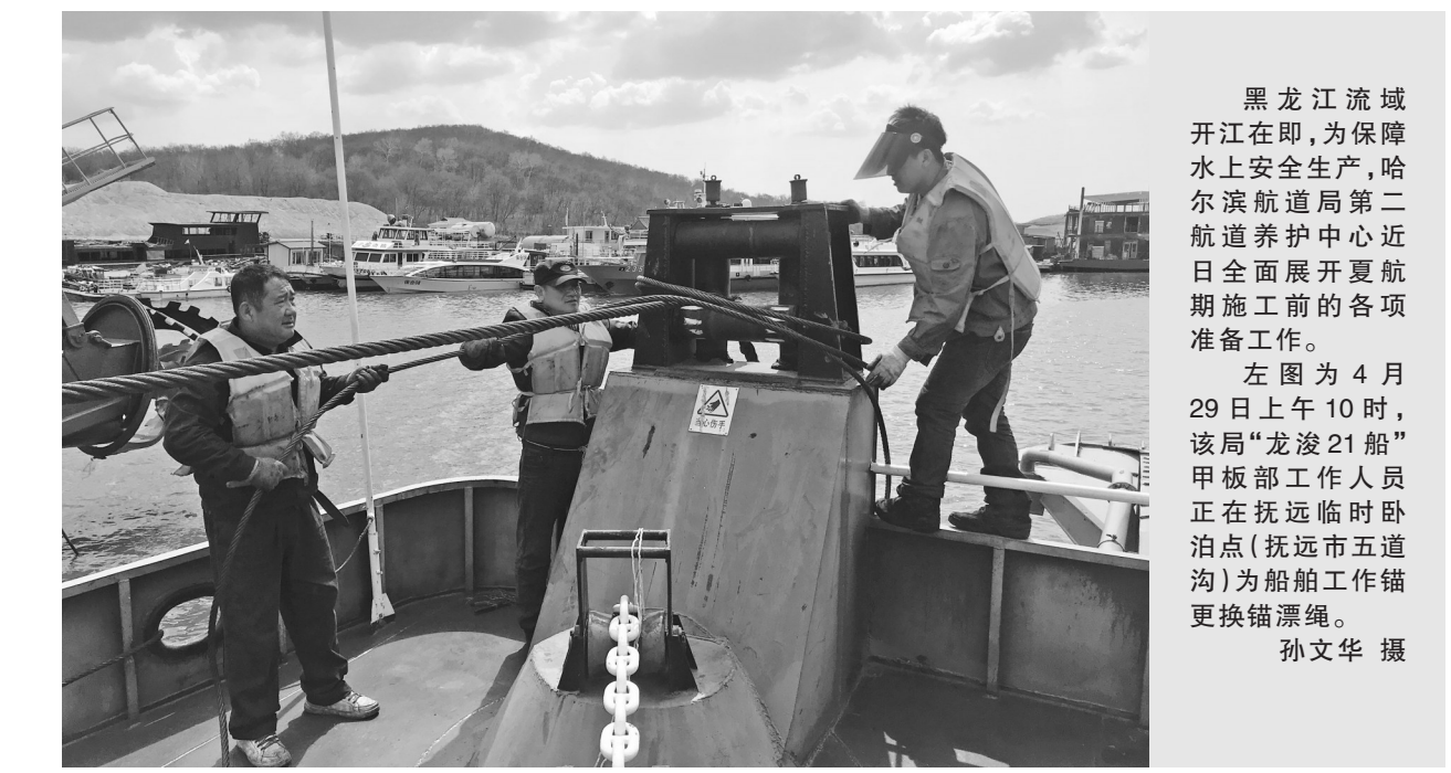
黑龙江流域开江在即，为保障水上安全生产，哈尔滨航道局第二航道养护中心近日全面展开夏航期施工前的各项准备工作。
