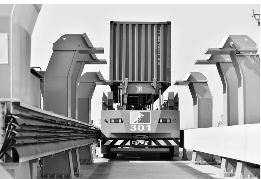
AGV导引车收放箱过程中即时充电。本文图片由青岛港供图
