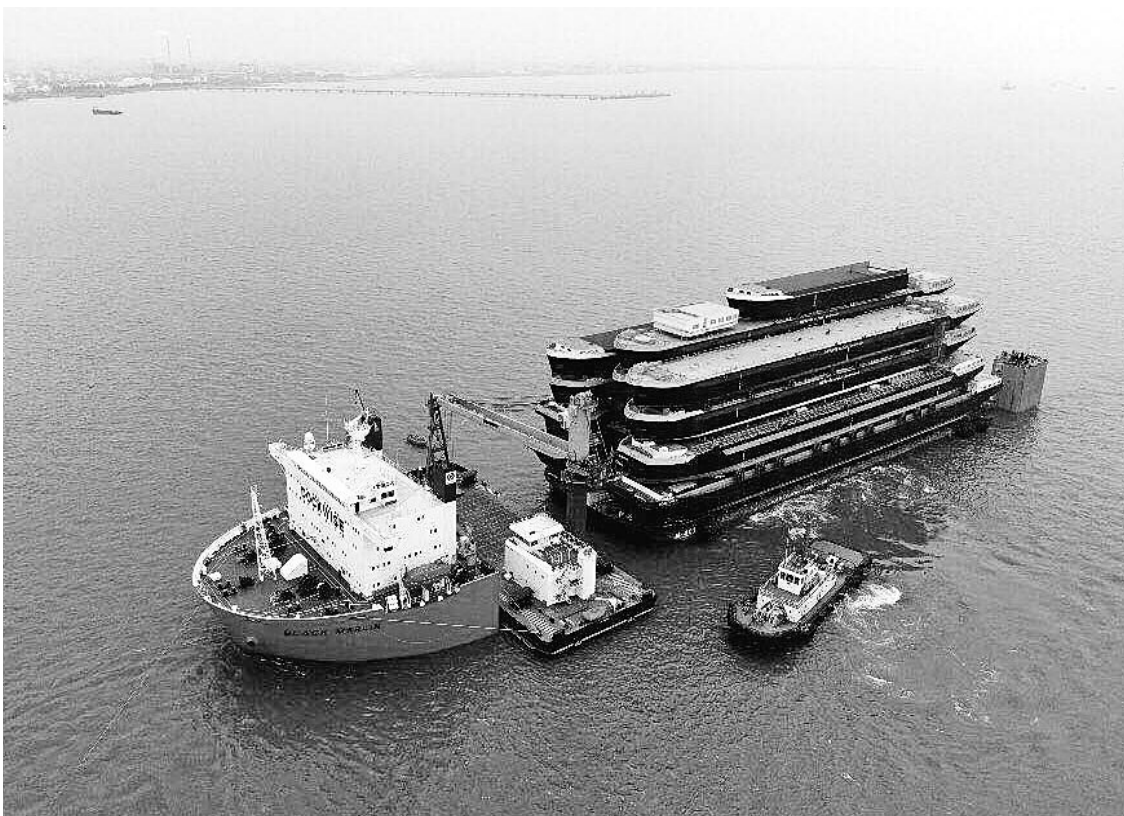
6月12日10时20分,在南通海事人员的全程监控和海巡艇现场维护下,半潜船“马林(BLACK MARLIN)”轮在南通狼山联锁锚地成功装载了来自南京、扬州、镇江等船厂建造的19艘驳船和1艘浮吊,创造了长江南通段一次半潜装船数量最多纪录。郝林 摄
