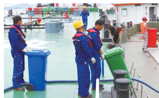
▲▲趸船上设有八个仓,最多可一次性接收油污水800立方米、生活污水400立方米以及船舶垃圾60立方米,定期通过有资质的垃圾接收单位送上岸统一处理。 王婷婷 朱亦乐 摄
