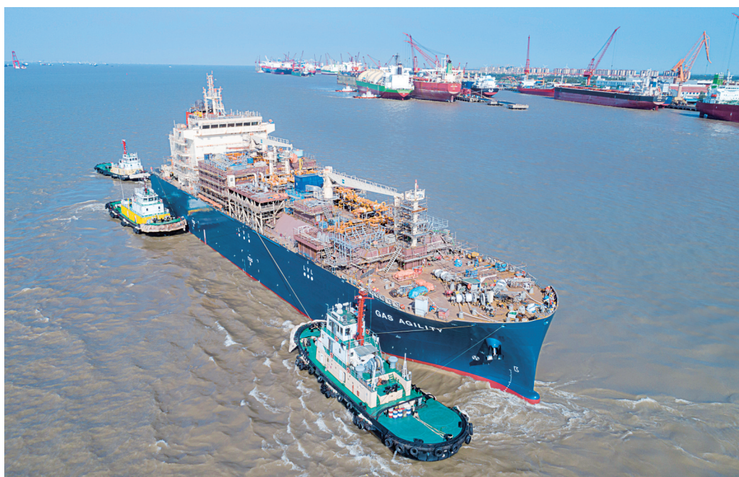
10月10日，世界最大的首款应用薄膜型Mark III Flex型围护系统LNG加注船在沪东中华长兴造船出坞。该船上建区域除主甲板以外其他区域设备接线已结
