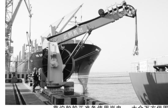
靠泊船舶正准备使用岸电。 太仓万方供图
