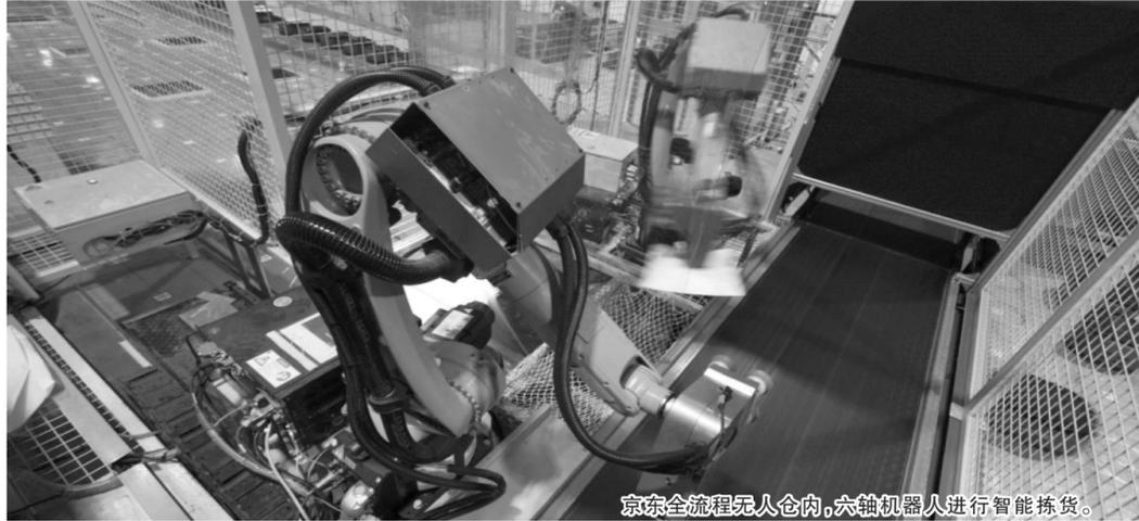
京东全流程无人仓内，六轴机器人进行智能拣货。
