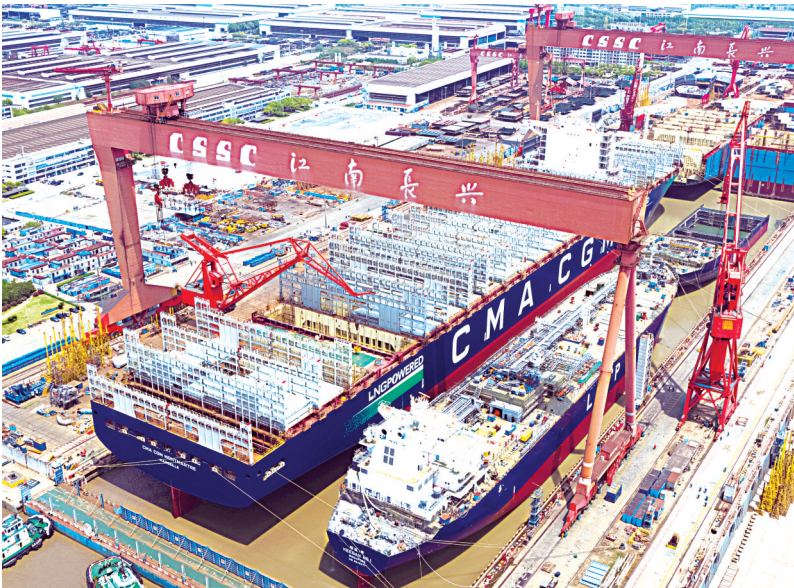
4月26日，中国船舶集团旗下江南造船3号船坞迎来了“两船出坞、两船起浮”节点。一艘84000方超大型液化气船和一艘23000箱集装箱船出坞后，两艘同类型船舶同时起浮。 江南造船3号船坞是目前国内在用的最大船坞。为充分提升船坞利用效率，江南造船采取“双线并造”模式，即一批次液化气船和一批次超大型集装箱船同时建造。 阮瑞旻 许煌伟 摄
