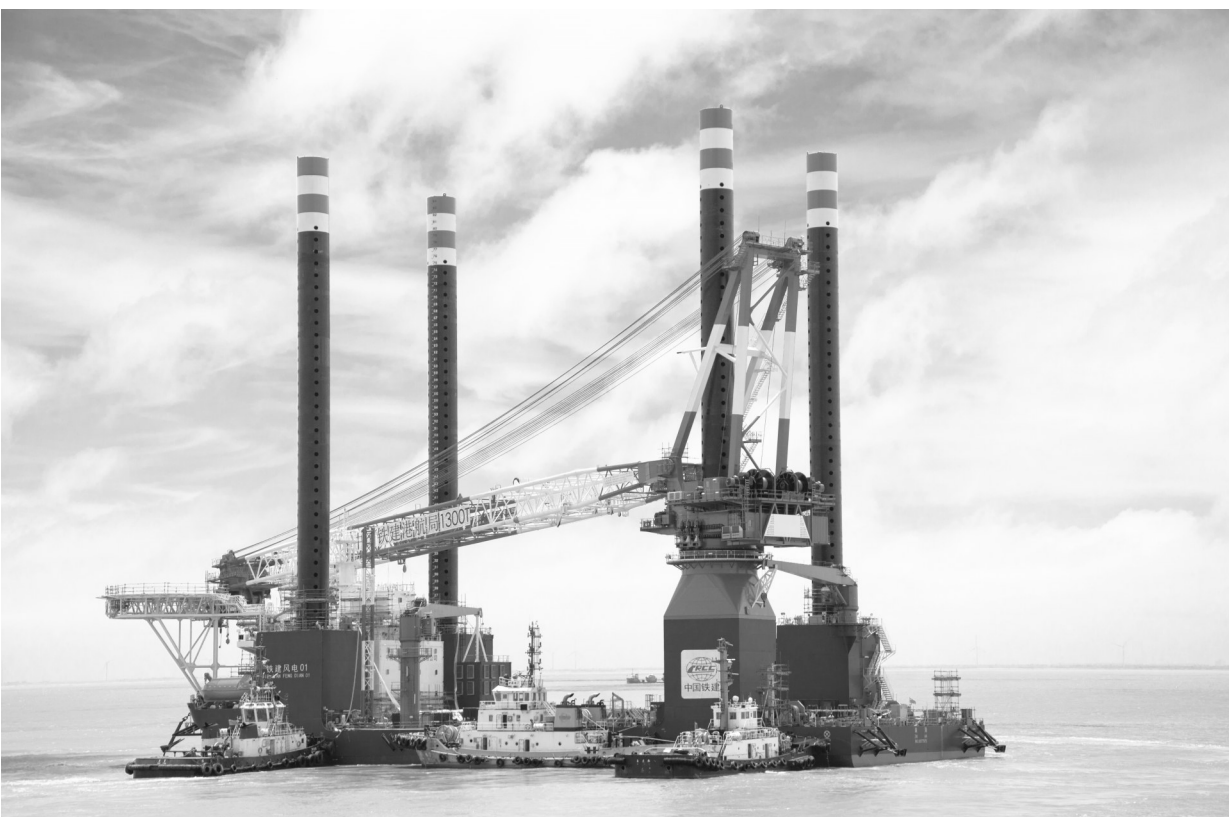
国内首个1300吨自升自航式风电安装船。本报资料室供图
