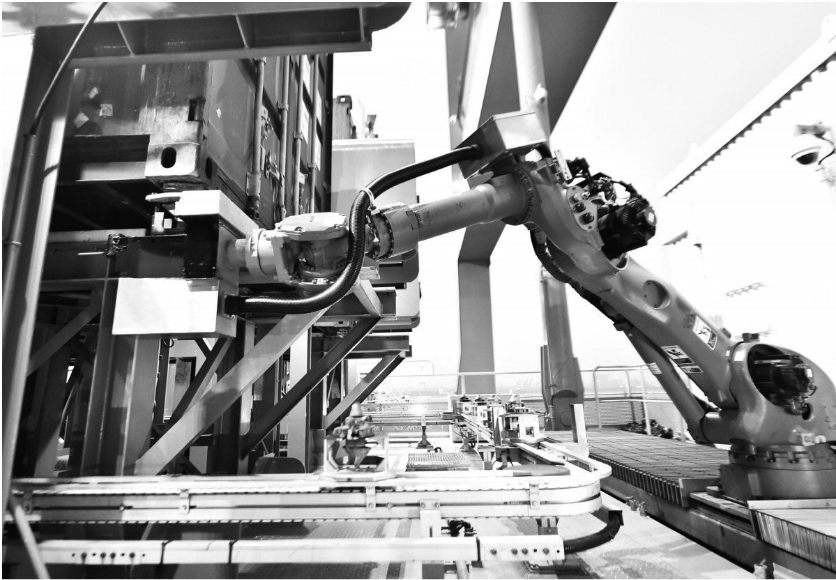
机器人自动装卸集装箱锁钮。本报资料室供图
