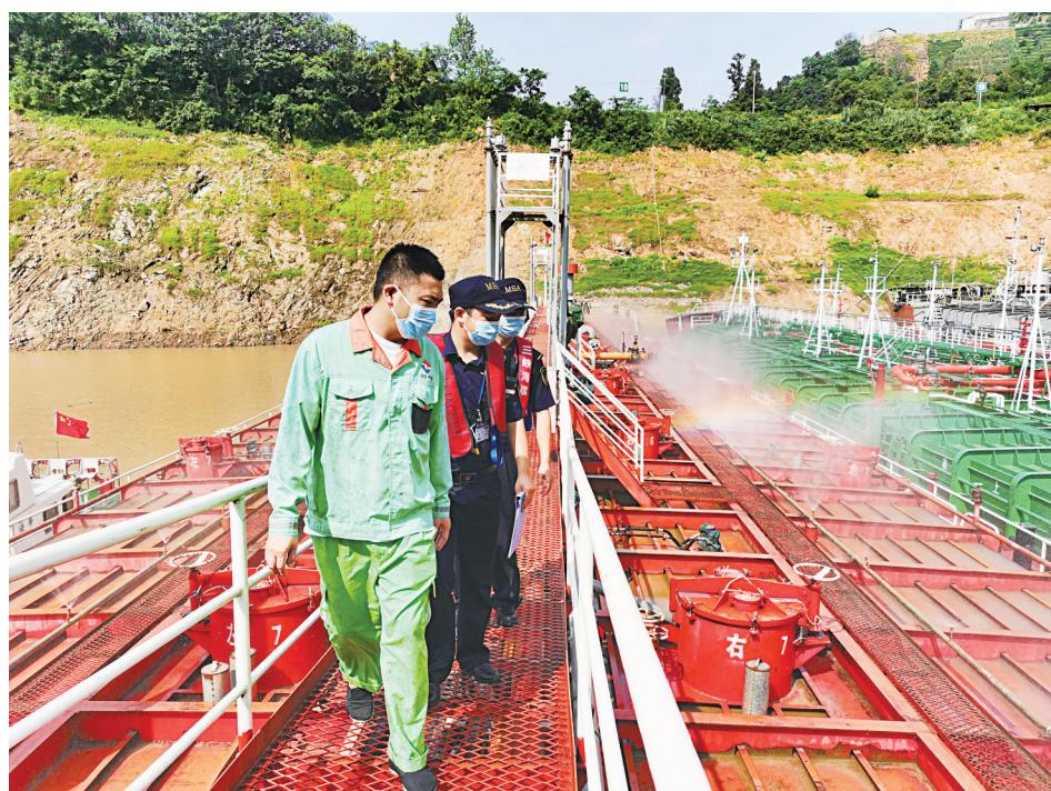
安检员在三峡通航管理局所属的庙河危险品待闸锚地检查危险品船舶的喷淋装置是否正常工作，并提示在气温高于28℃时需要常开喷淋。
