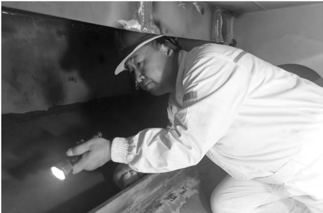
刘杰检查5200DWT散货船顶边舱结构及焊接。杨柳 摄
