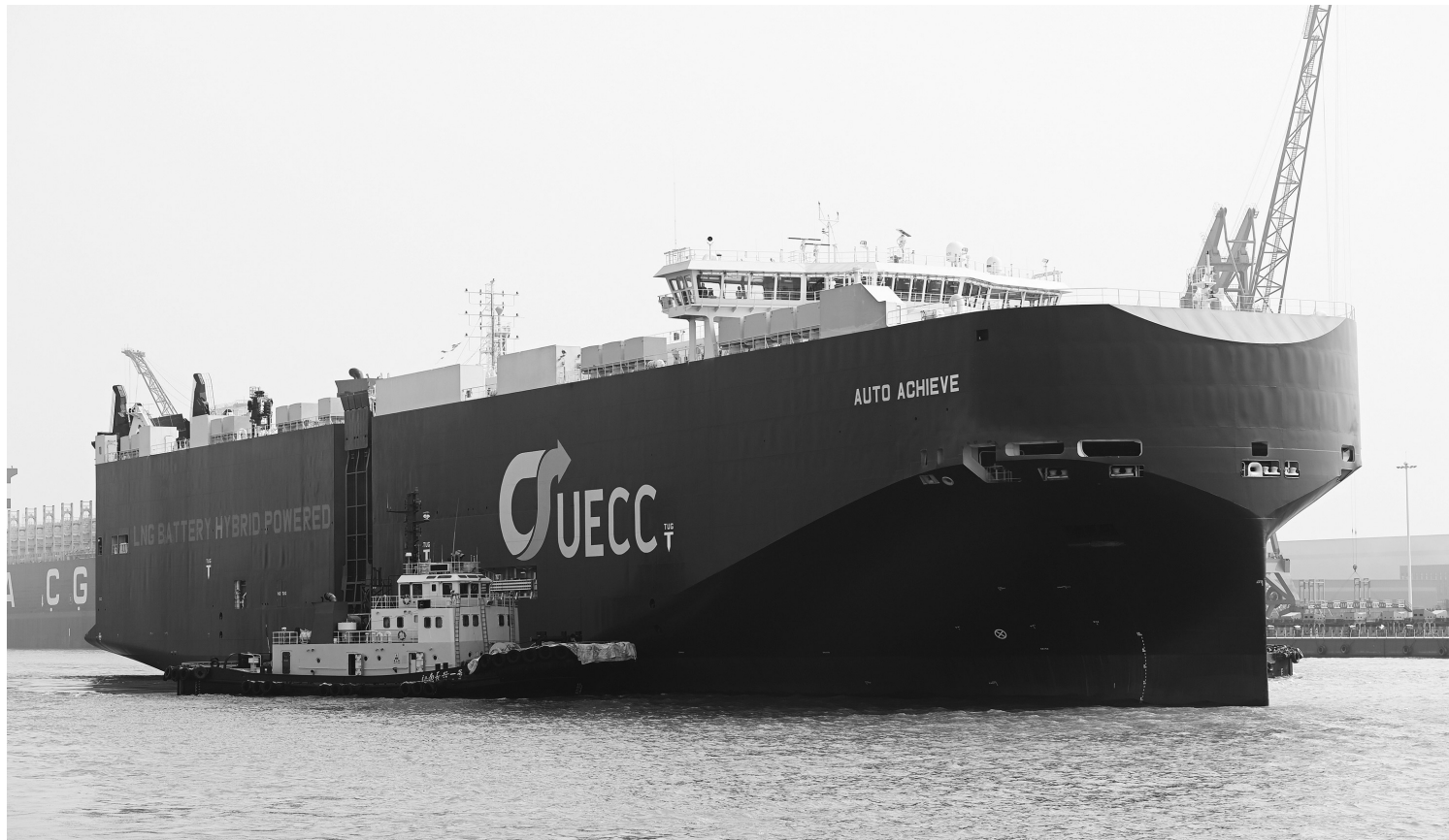
“LNG双燃料+电池”混合动力汽车滚装运输船。本报资料室供图
