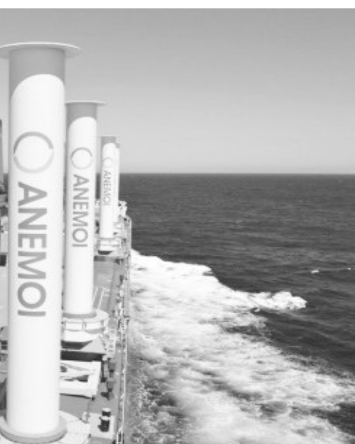
英国Anemol船舶技术公司的旋筒风帆。瓦锡兰公司供图
