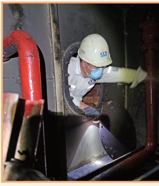
近日,广州气温达到36℃,船舱内部温度超过40℃。中国船级社广州分社国内处验船师侯建军克服船舱内高温闷热,对某轮压载舱进行内部检查。 张百慈 摄
