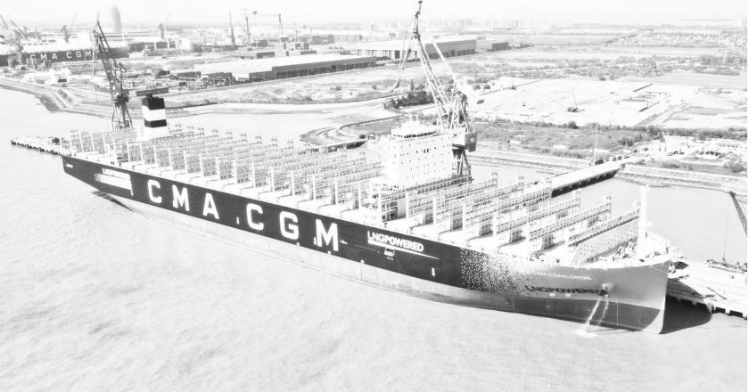
23000箱双燃料动力超大型集装箱船。
