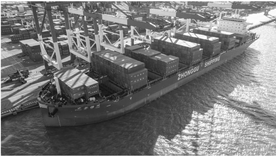
12月17日上午，国内最大内贸集装箱船“中谷福州”轮首航辽港集团营口港。“中谷福州”轮是中谷海运建造的4600TEU国内最大内贸集装箱船之一，满载吃水量达10.3万吨，总长约228米，型宽40米，最大载重量约8.7万吨，最大载箱量达到4636个标准集装箱。该轮是首条在营口港正式运营的10万吨级集装箱船舶，刷新了营口港内贸最大单船吨位纪录。
