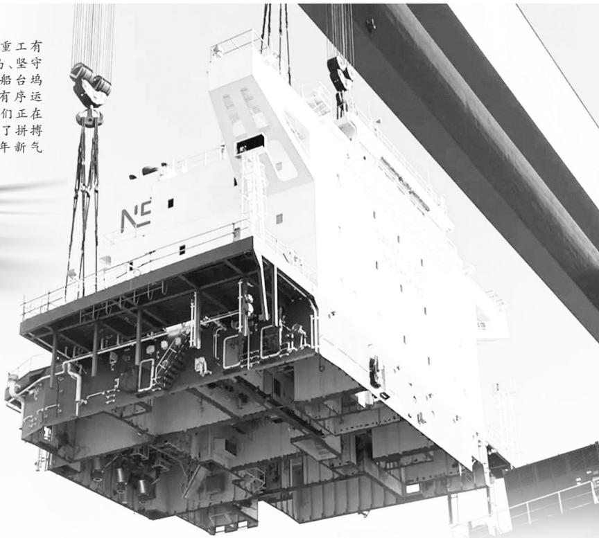
▲1月17日,舟山中远海运重工在建6.36万吨系列散货船首制项目N1086顺利实现主机吊装节点;1月26日,该船又成功实现上建90A总段整体吊装定位节点,且首次采用烟囱和上建整体总吊吊装方式,大幅降低了建造成本,提高了施工效率。
