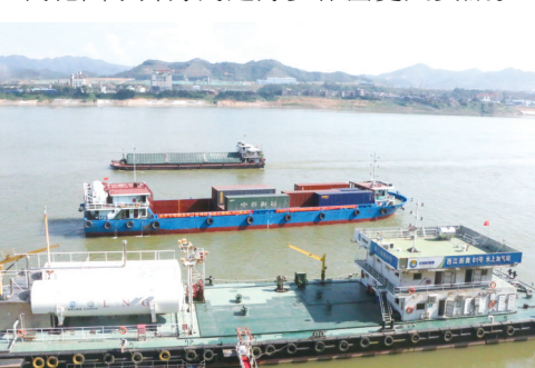
西江干线上的LNG加注站和LNG新能源集装箱船。
