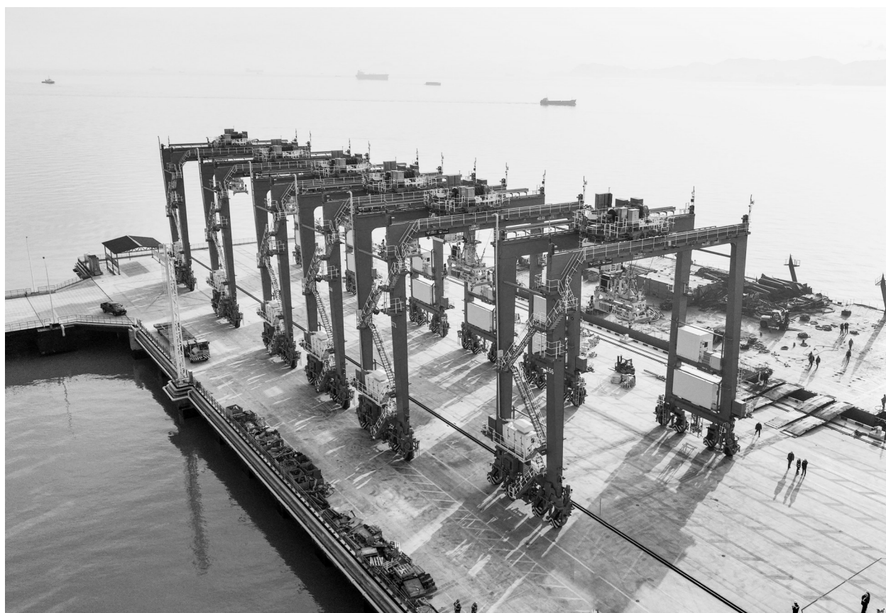
宁波舟山港梅山港区6台油电混合动力远控自动化龙门吊投入使用。汪舒婷摄
