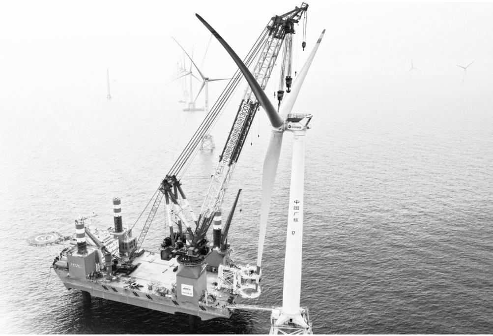
“铁建风电01”1300吨自升自航式风电安装船。本报资料室供图
