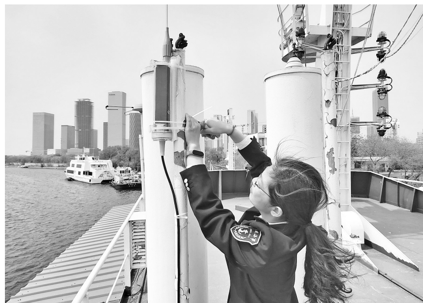
全场景多构型 AIS 接收站安装测试。
