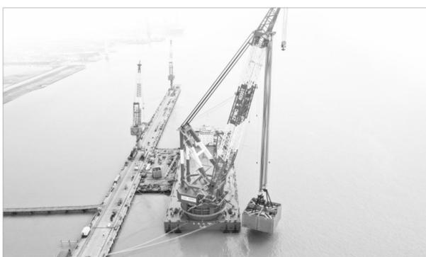
4000吨全回转起重机进行重载试验。
