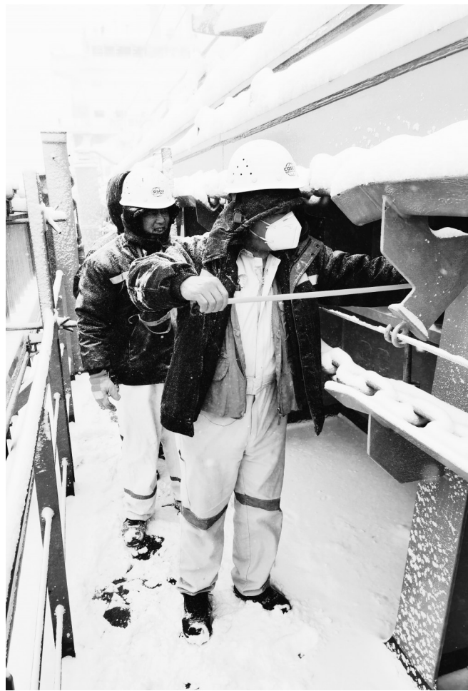
大连中远海运重工质量管理部会同船检人员冒雪进行新造船甲板舱盖相关检验检测工作。 高振全 摄
