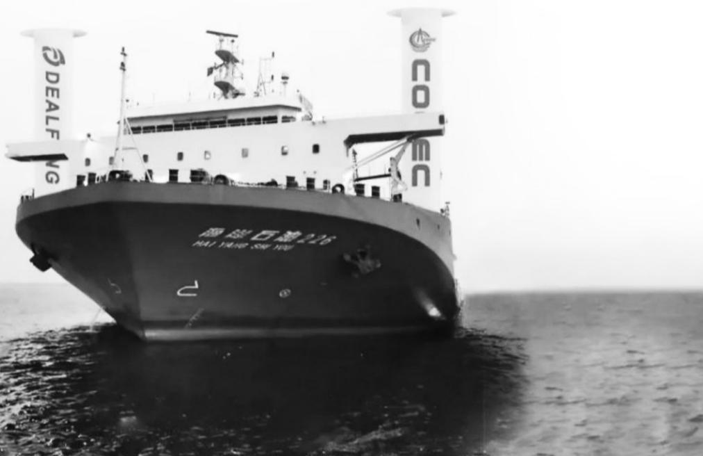
叠风新能源承接的“海洋石油226”船用风力旋筒助推系统改造的设计及制造安装工作。中海油集团供图
