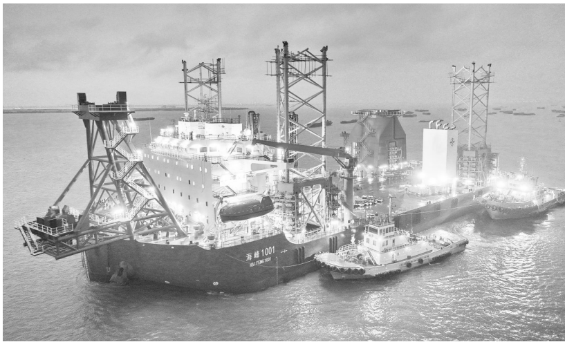
自升自航式风电安装平台“海峰1001”。上海振华重工供图
