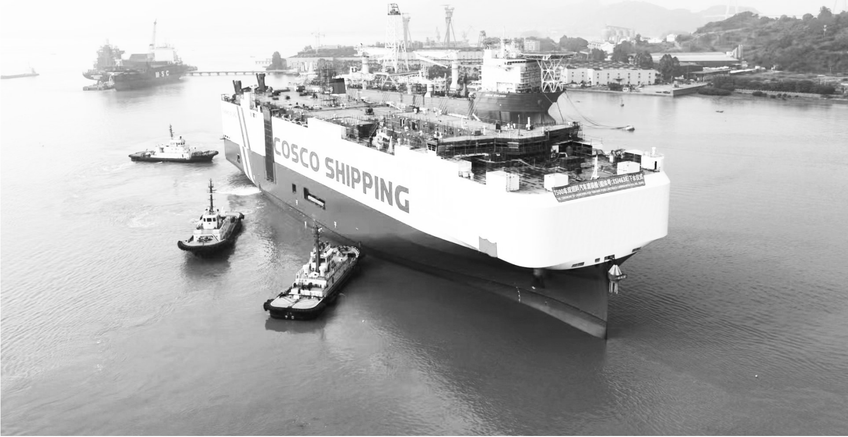
7500 车位 LNG 双燃料汽车滚装船。 马尾造船供图
