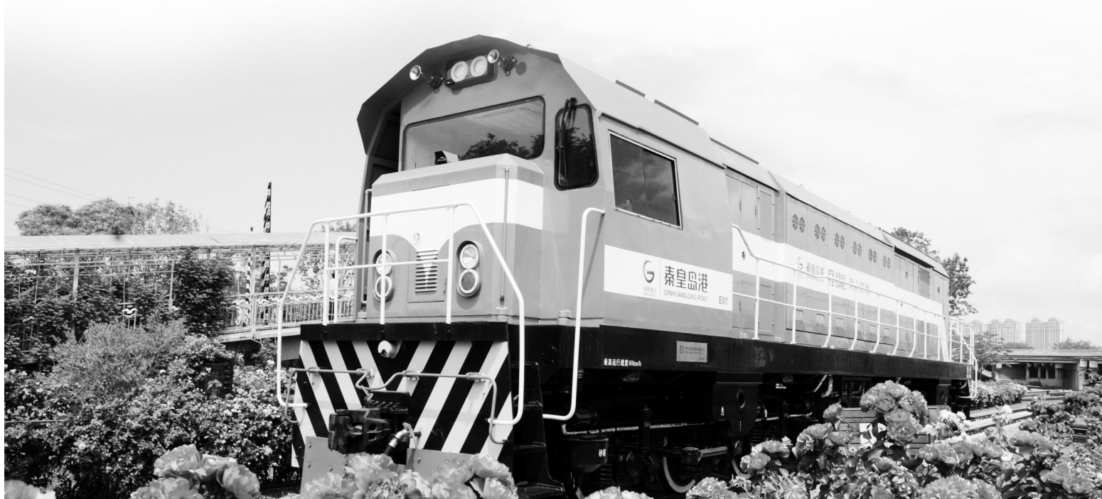
国内首台完成纯电动化改造的退役内燃机车。秦港股份供图
