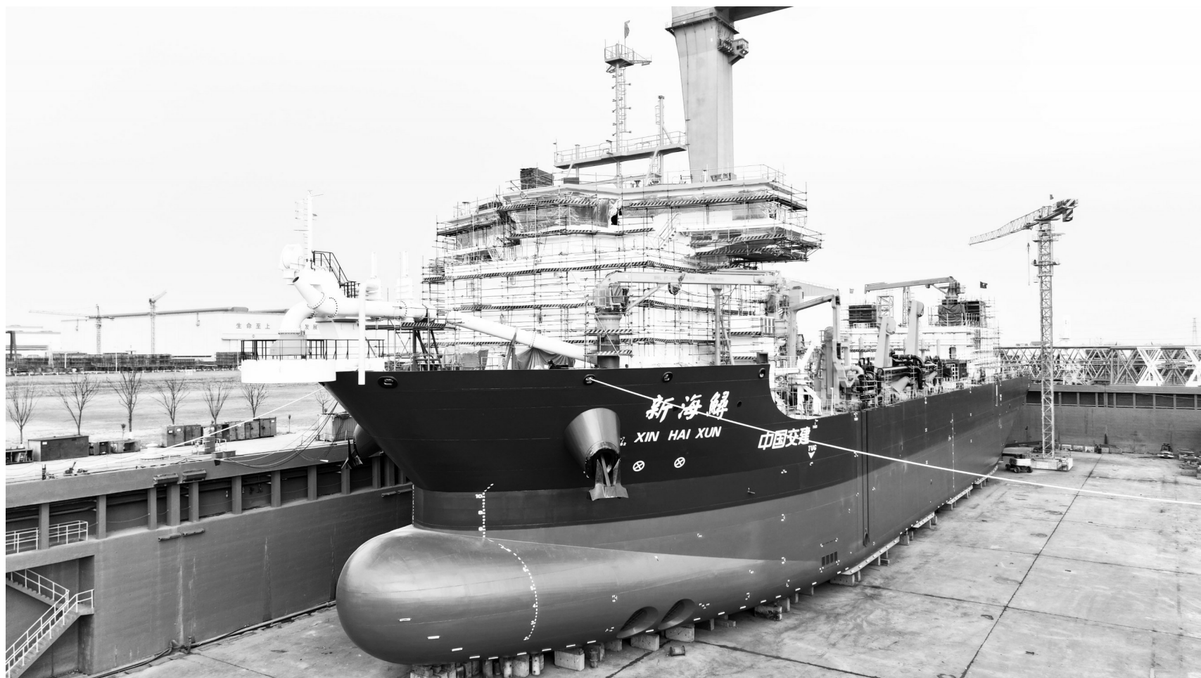
15000立方米舱容LNG清洁能源动力耙吸挖泥船“新海鲲”号。
