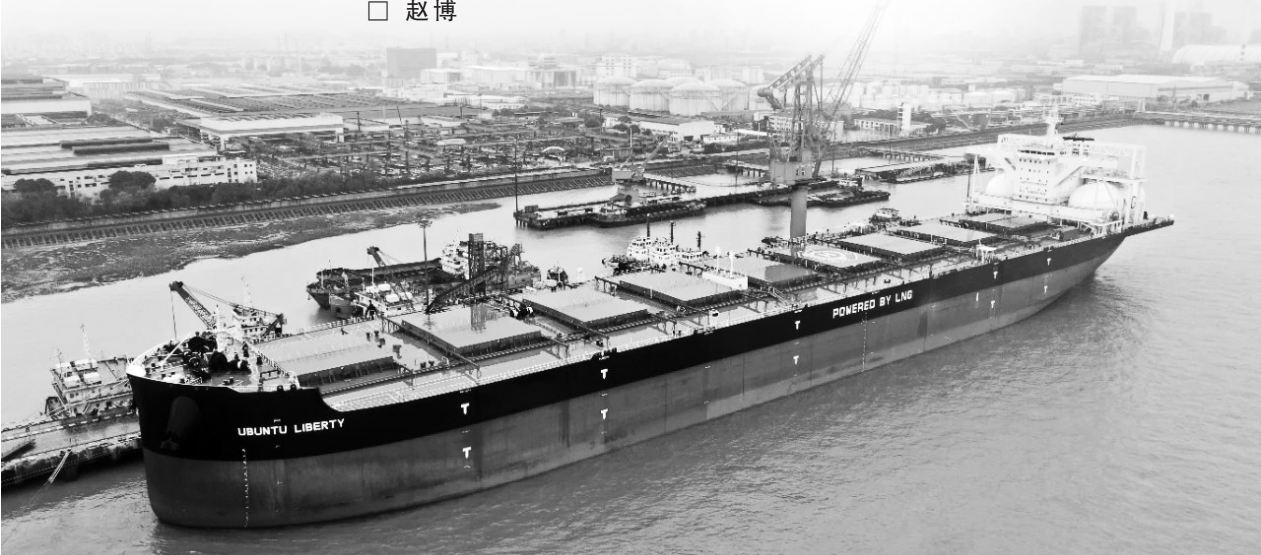
LNG 双燃料动力好望角型散货船。 本报资料室供图
